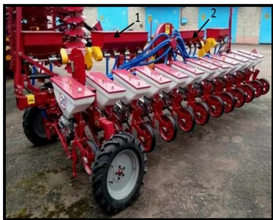
Рис. 10.22. Общий вид сеялки СТВ-8У; 1 – комплекс туковысевающих аппаратов АТП-2; 2 - сдвоенные туковысевающие аппараты АТП-2
