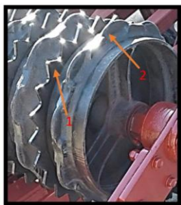
Рис. 8.6. Кольчато-зубчатые рабочие диски кольчато-зубчатого катка КЗК-6У: 1 – каток зубчатый; 2 – каток кольчатый.
