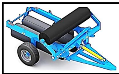
Рис. 8. 2. Каток водоналивной полуприцепной гладкий гидрофицированный КВНГ-6 в транспортном положении.
