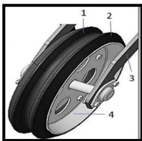
Рис. 10.17. Колесо, прикатывающее заднее составное сеялки СТВ-12: 1 – ребро левая; 2 – ребро правая, 3 – рамка; 4 – полуколесо правое.
