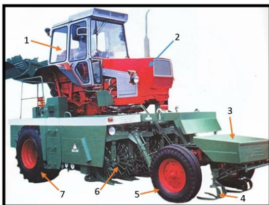
Рис. 15.23. Общий вид комбайна свеклоуборочного РКС-6: 1 – кабина трактора; 2 – Трактор; 3 – рама копир-водителя; 4 – копир-водитель; 5 – колесо опорно-регулирующее управляемое; 6 – корнекопатели; 7 – колесо опорно-ходовое.
