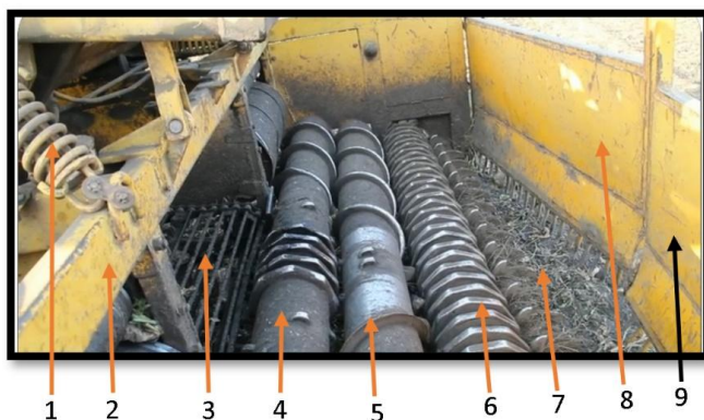
Рис. 15.38. Общий вид погрузочно-сепарирующего устройства самоходного свеклопогрузчика-очистителя СПС-2А: 1 – пружина; 2 – рама; 3 – транспортёр-сепаратор; 4 – шнек сужающий; 5 – шнек-очиститель; 6 – битер подающий; 7 – питатель кулачковый; 8 – щит подгребающий левый; 9 - щит подгребающий правый.
