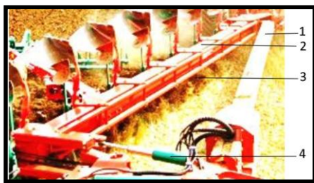
Рис. 3.32. Общий вид плуга: 1 – продольный брус рамы; 2 – главный брус рамы; 3 – корпус рабочий; 4 – гидроцилиндр.
