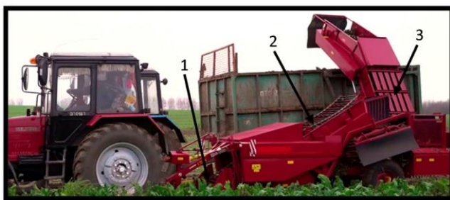
Рис. 15.39. Общий вид прицепного подборщика-погрузчика ППК-6А: 1 – устройство подбора валка корнеплодов из валка; 2 – устройство сепарирующее; 3 – устройство погрузочное.
