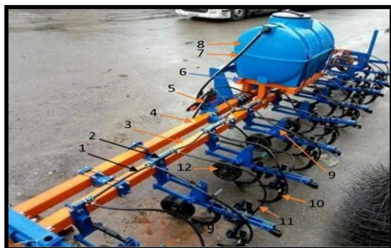
Рис. 14.4. Общий вид культиватора УСМК-5,4Б в варианте опрыскивателя: 1 – шланг подвода рабочей жидкости к секциям; 2 - тройник подвода рабочей жидкости к секциям; 3 – главный брус рамы; 4 – дополнительный брус; 5 – распределитель рабочей жидкости по рабочим секциям; 6 – рамка. установки бака; 7 – шланг; 8 – бак для рабочей жидкости; 9 – секция рабочая; 10 – форсунка-распылитель рабочей жидкости; 12 – колесо секции опорное.
