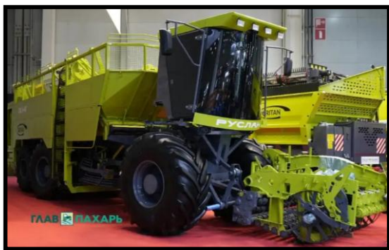
Рис. 15.41. Общий вид самоходного свеклоуборочного комбайна GRITAN Руслан СКС 6-45.
