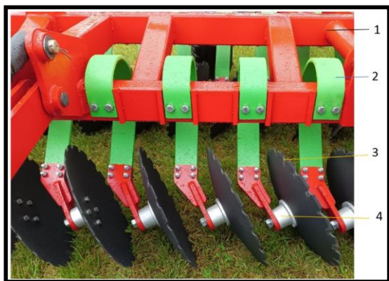
Рис. 6.7. Общий вид подвески дисков луцильника дискового Вектор МЛ-10000ПС: 1. Рама секции дисков; 2 – стойка рабочих дисков эластомерная; 3 – рабочий диск; 4 – втулка оси вращения диска.
