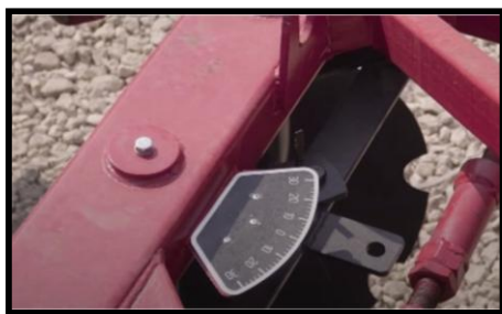
Рис.6.11 Общий вид шкалы регулировочного устройства угла атаки дисковой борона БД-2,4х2Н.
