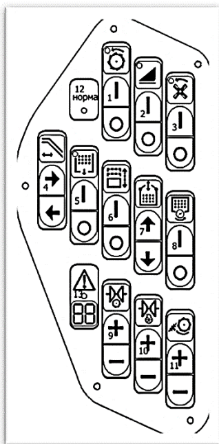
Рис.1. Клавиши пульта управления рабочими органами комбайна РСМ-142 ИЭ: 1 – клавиша управления ленинком молотилки, 2 клавиша управления ленинком наклонной камеры, 3 - клавиша управления ленинком ИРС, 4 - клавиша управления положением выгрузного шнека, 5 - клавиша управления ленинком выгрузки зерна, 6 – клавиша включения вибратора бункера, 7 - клавиша управления створками крыши бункера, 8 - клавиша управления горизонтальным шнеком бункера, 9 - клавиша управления вариатором молотильного аппарата, 10 - клавиша управления вариатором вентилятора очистки, 11 - клавиша управления механизмом установки зазора деки, 12 – светодиод «НОРМА»,
